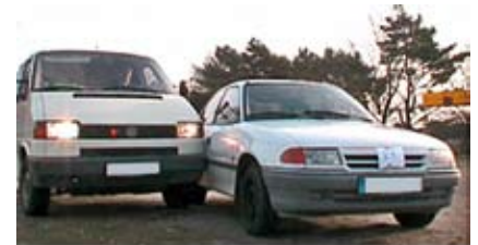
BILD 1: Anstoßwinkel beim Kollisionsversuch 1 FIGURE 1: Impact angle during collision test 1
