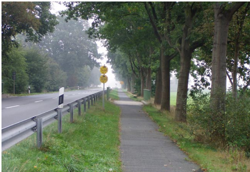
BILD 1: Mit dem nicht vergrößernden Visier einer Riegl-Laserpistole LR90 235P wäre der in zirka 350 m Entfernung stehende Vorwegweiser nicht anpeilbar
