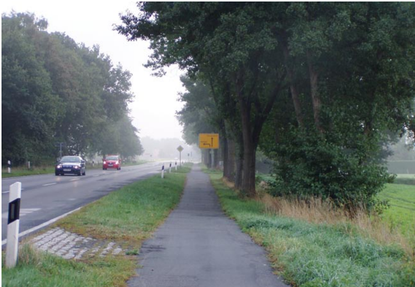
BILD 3: In 150 m Distanz ist ein Vorwegweiser ein geeignetes Ziel für die Visierüberprüfung (Riegl LR 90)
